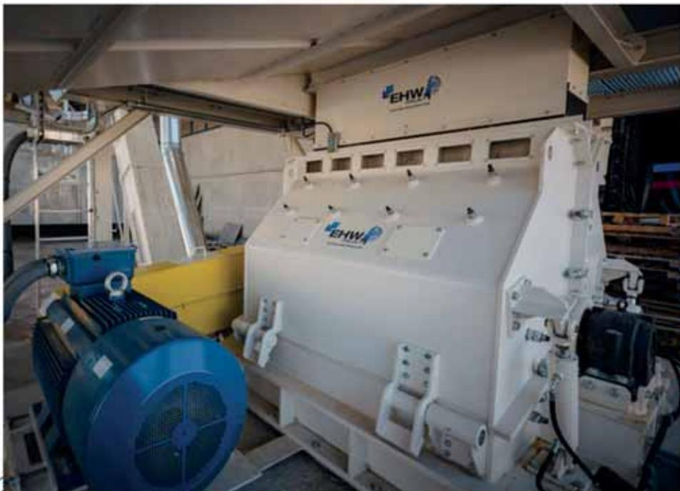
I nostri mulini a martelli, dotati di robusti telai, sono ideali per la riduzione e macinazione della materia prima, sia umida che secca, al fine di raggiungere una dimensione granulometrica ideale.
