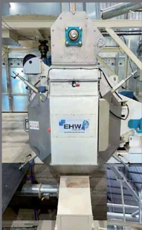
EHW Italia dispone di presse di diverse dimensioni e capacità: il diametro delle nostre trafilare parte da 420 mm fino a 1200 mm., i motori principali vanno da 75 a 630 Kw per capacità produttive da 0,8 a 10 ton/h.
